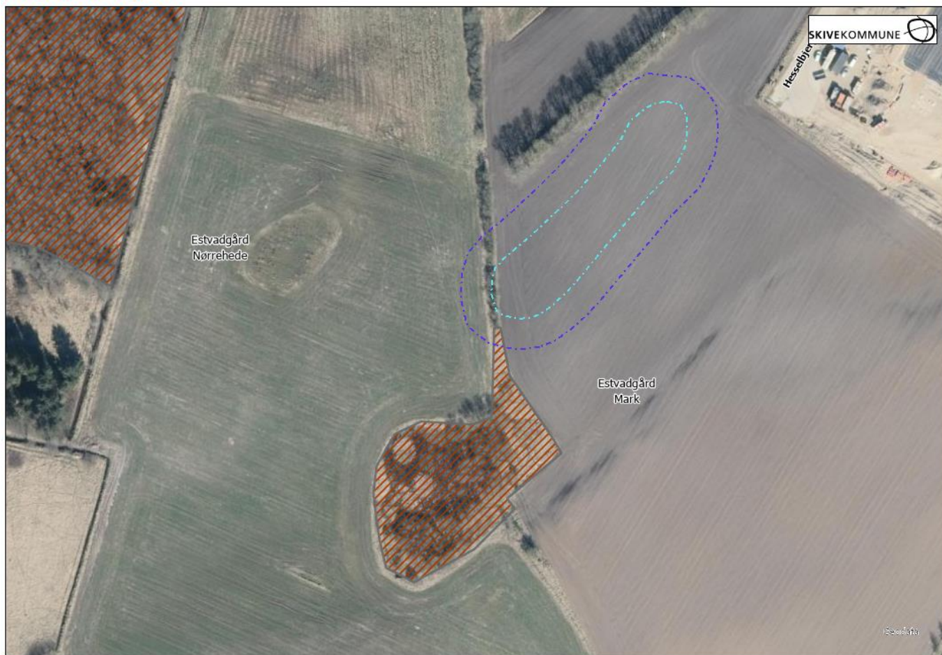
Kort 3 - De to stiplede linjer vise den midlertidige sænkningstragt på hhv. lyseblå (6 meter) og den mørkeblå (20 meter) som er worst case tilfældet. I worst case tilfældet vil sænkningen lige berøre den nordlige del af mosen i en kort periode.
