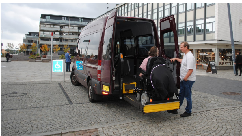
Billede 124: Handicapparkeringspladser til minibusser bør være 8 meter lange.
