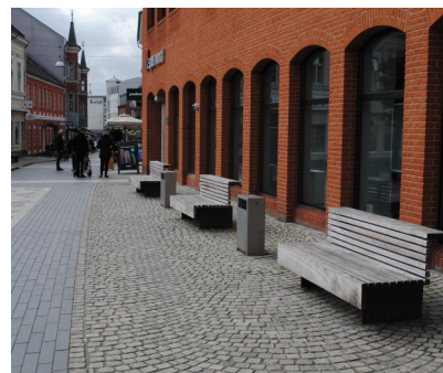
Billede 128: Bænke i gågaden. Bænken er udført med ryglæn, men uden armlæn. Siddehøjden er desuden for lav.
